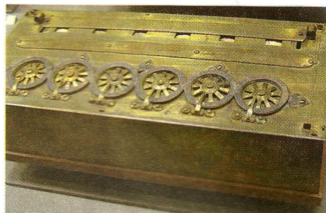
Pascalina. Contaba con una serie de ruedas dentadas que representaban los dígitos del 0 al 9. El movimiento de las ruedas, enlazadas entre sí, proporcionaba el resultado de las operaciones de sumar o restar. Este principio se aplicó a las máquinas registradoras durante mucho tiempo.
